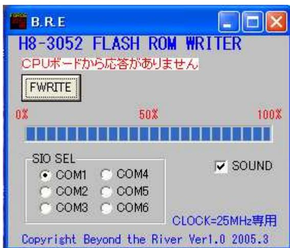
電源、「H83052」CPUボードの設定、Eケーブルの接続がOKだとすると「COM番号」が違う可能性があります。別記の「COM番号を調べる、」を参照し、再度確認してください。
