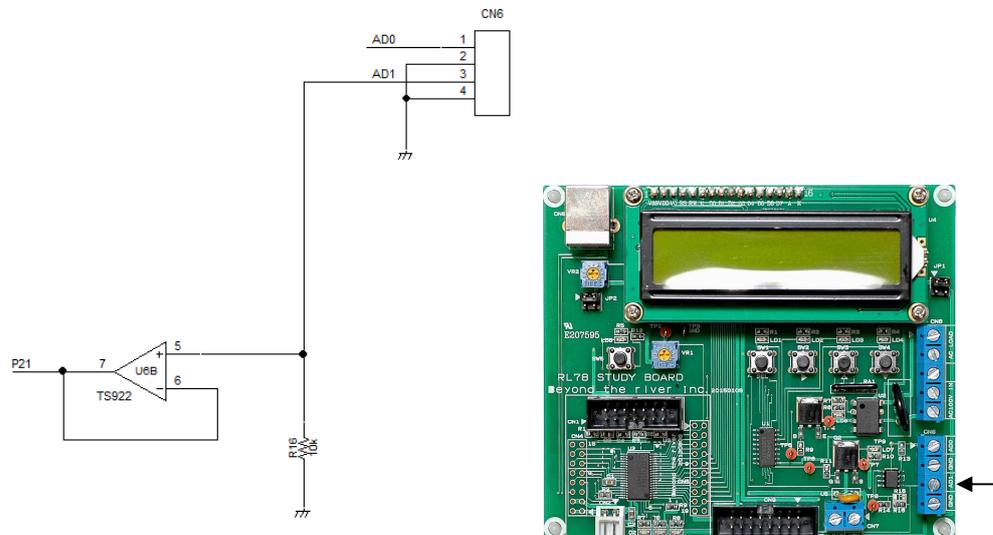
U6BのオペアンプTS922は入力に1Vが入ったときに出力に1Vを出します。電圧増幅が1倍です。電圧増幅が1倍で、何のために入っているか(入れる必要があるのか?、線でつないであるのと同じでは?)というインピーダンス変換のために入っています。
