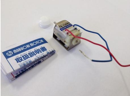
プログラムを動作させると初め0%出力ですので、モーターは回りませんが、SW1を押すと出力が増加していきます。50%を超えたあたりから回転が確認出来ます。減速はSW2を押します。
