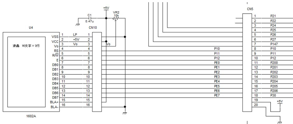
使われているキャラクタタイプ液晶は1602Aです。例えば秋月電子やストロベリーリナックスで販売しているものと使い方は同じです。理由はコントロールIC、HD44780（または互換品）がこのキャラクタLCD駆動のデファクトスタンダード（業界標準）だからで、世界中同じです。
