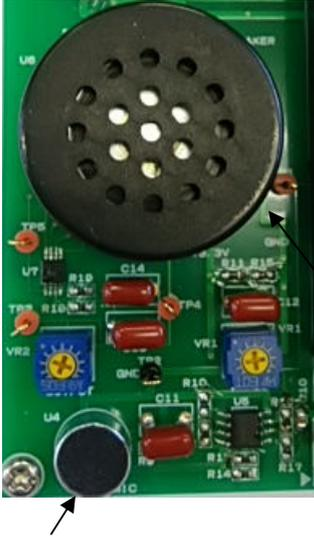
マイクで話した言葉をA/D変換、マイコンの内蔵メモリに記録し、スピーカーからD/A変換で再生します。録音のボリュームは大きめ（右回りで大きくなります）、再生のボリュームは大きくし過ぎると音が割れてしまいます。
