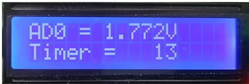
声が無いときは  $3.3\text{V} / 2 \approx 1.65\text{V}$  前後の電圧が液晶に表示されます。声を上げて行くと最大  $3.3\text{V}$  付近まで電圧が上がり LED が明るく点灯します。5 秒間ごとに保持電圧がクリアされ、新たに声を待ち受ける状態になります。
