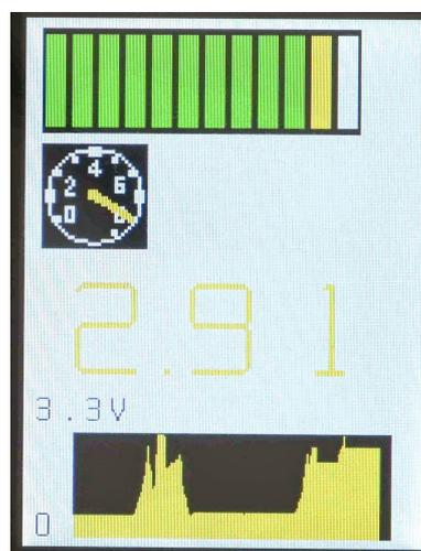
液晶表示器は 2.8 inch 240×320 ドットフルカラー TFT 液晶、SPI 接続、3.3V 動作です。
