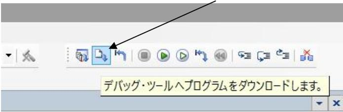
上手く転送できると、今まで表示されていなかったプログラムの絶対番地が表示されます。E1から電源がCPU基板に供給されます。(E1 VCC オレンジLED点灯)
