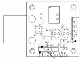
バスパワーを使用する場合、J`P 1をジャンパー線を半田つけしてショートしてください。(回路図ご参照。出荷時オープン)
